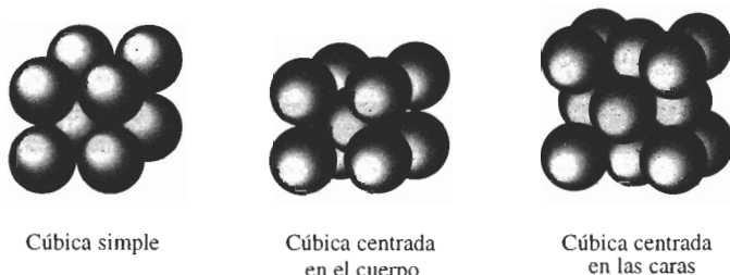
FIGURA 3-6 Los modelos de celdas unitarias cúbica simple (CS), cúbica centrada en el cuerpo (CC) y cúbica centrada en las caras (CCC), suponiendo un solo átomo por punto de red.
